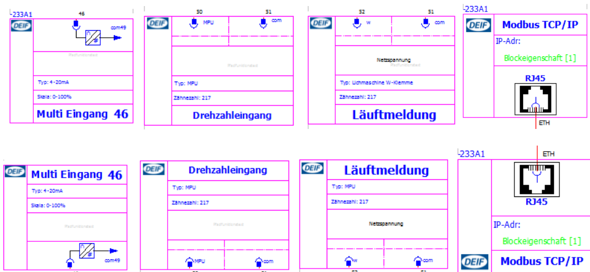
Abbildung 8 AGC200 allpolige Darstellung analoge Eingänge, RJ45 Anschluß
