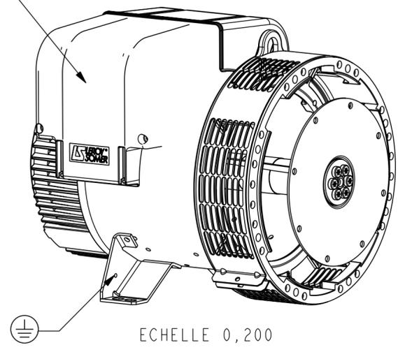
Sortie des cables Gauche vue bout d'arbre en STD
